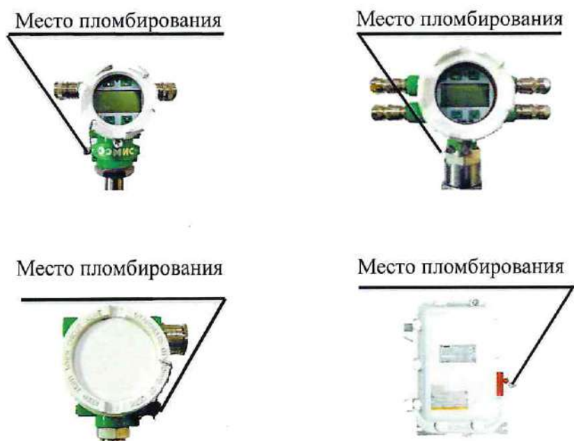
Рисунок 6 - Места нанесения защитных пломб
